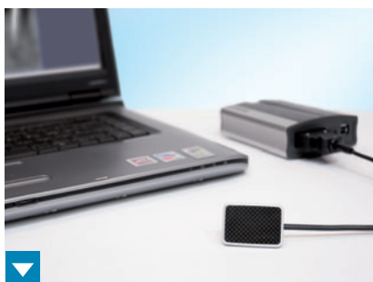
Unité de commande du VistaRay 6 pour l'utilisation mobile avec un ordinateur portable.
